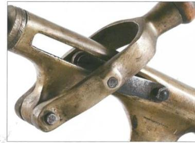
**LE TIRE-BOUCHON** Ce tire-bouchon est intéressant pour sa facilité d'utilisation et sa rapidité. Fixé solidement à une table, il était fort utile lorsqu'il fallait déboucher quelques centaines – ou pire quelques milliers de bouteilles – en raison d'un problème technique : précipitation de bi-tartrate de potassium (tartre) ou dépôt important.
