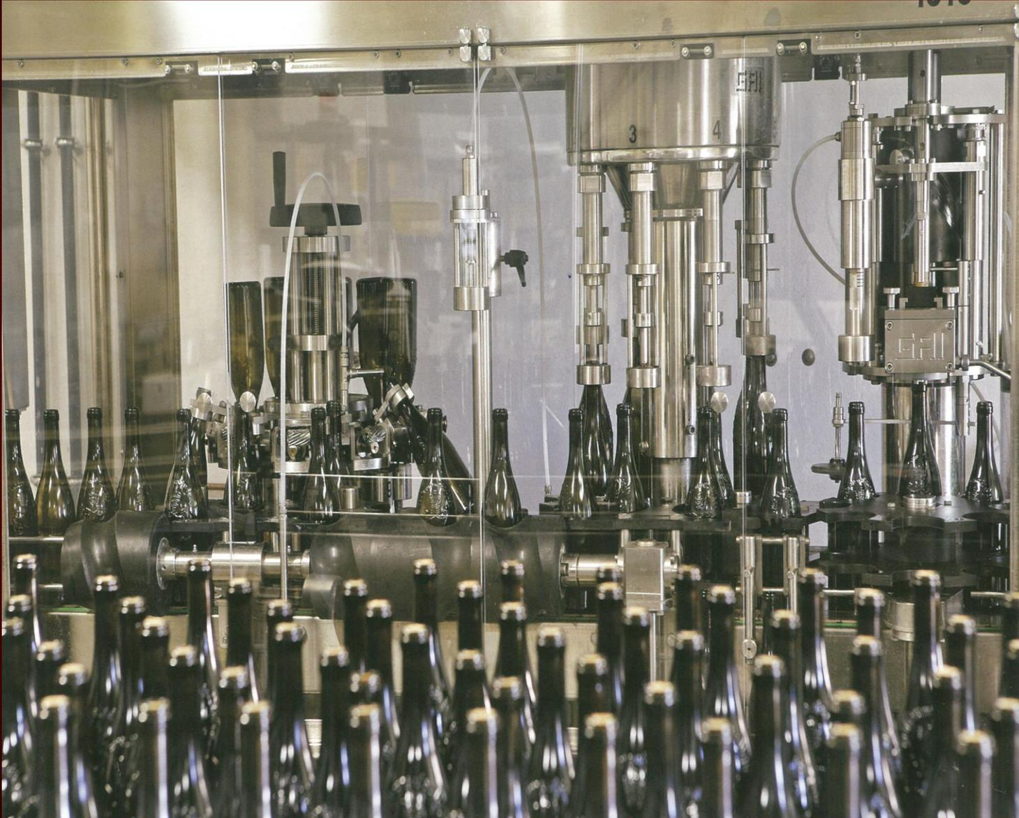
*La « ficelle » qui actionnait le capsulateur précédent a été remplacée par ce groupe d'embouteillage très performant qui positionne les bouteilles munies d'un ergot, capsule et colle les étiquettes adhésives sur les bouteilles.*
